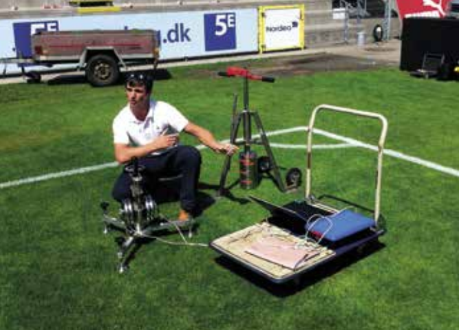
Præsentation af kunstig atlet, som bruges til at teste banens spilegenskaber.
